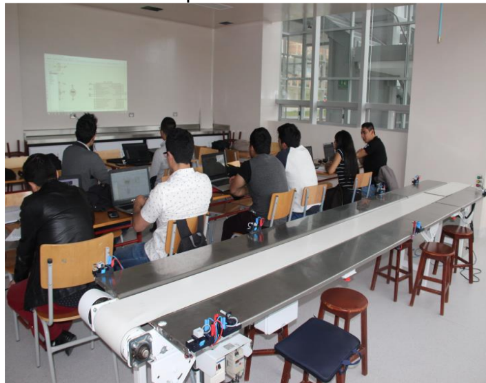
Figura 12. Sistema de banda transportadora
